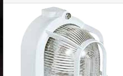
Le plafoniere ovali e tonde della serie RINO sono apparecchi di illuminazione realizzati con gli standard qualitativi dei prodotti ad uso industriale. Il diffusore in vetro temperato antiurto, il portalampada in porcellana e il trattamento superficiale di fluorozirconatura e verniciatura a forno del corpo, garantiscono grande resistenza del prodotto in qualsiasi ambiente applicativo.
